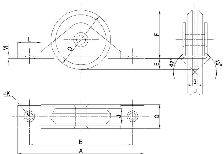
※枠、芯棒の材質はSUS304、車の材質はPOM成型加工です。
