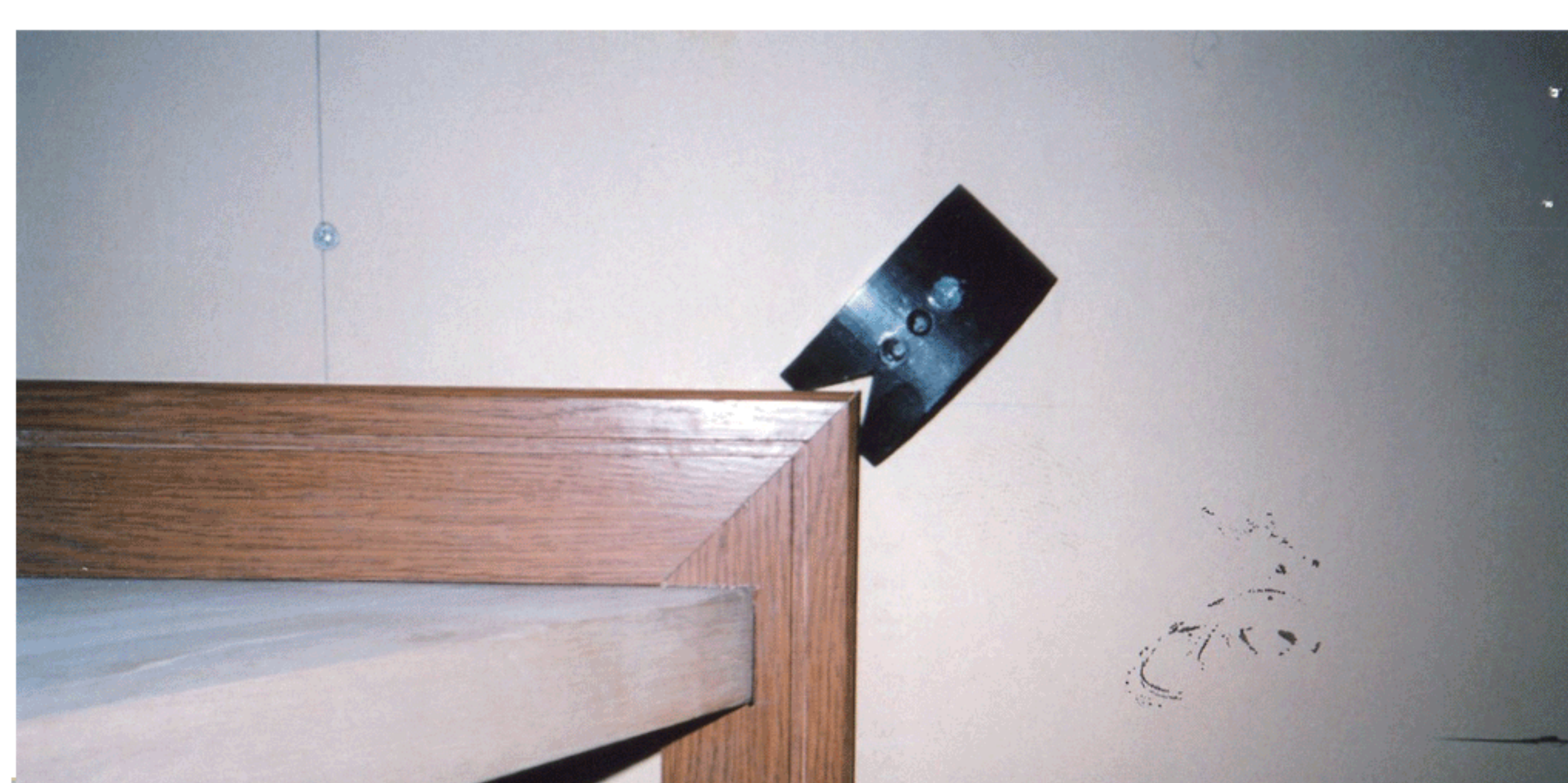
(天井の石膏ボード張り補助具)
