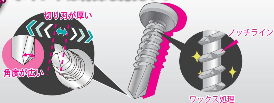
先端部のドリル切り刃が厚く刃先角度が広い為、挿入時に安定し、曲面や厳しい体勢での打ち込みを可能に! また、ネジ部に入ったノッチラインと表面のワックス効果でよりスムーズな入りを実現!
